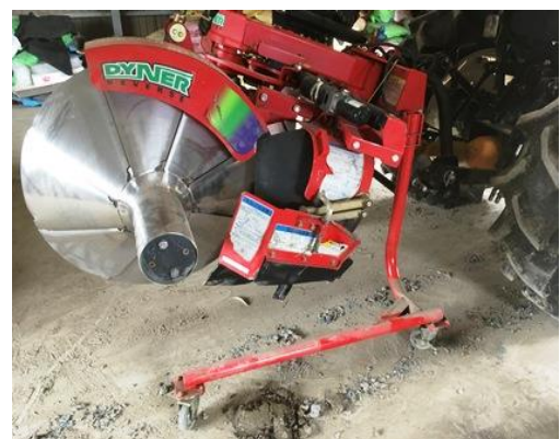
畔塗機収納時は左右に足を付ける (左右で足の形が違うので注意)
