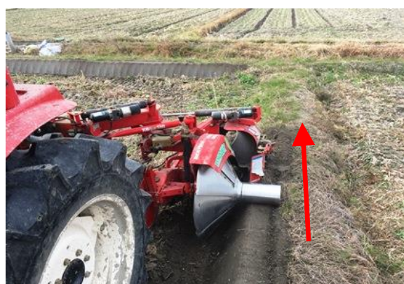
構造上(攪拌機が先)、バックで施工
