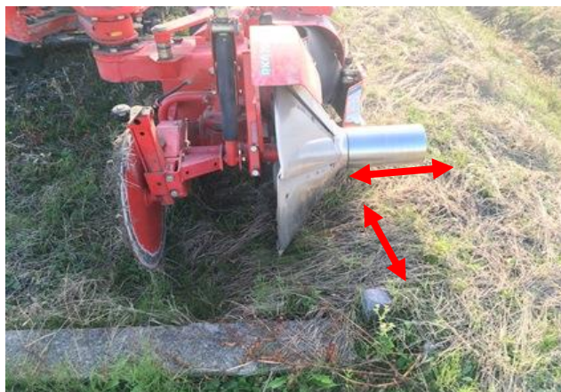
スタート位置(前後・左右)はPTOを切って 畔塗機を下ろして確認・調整
